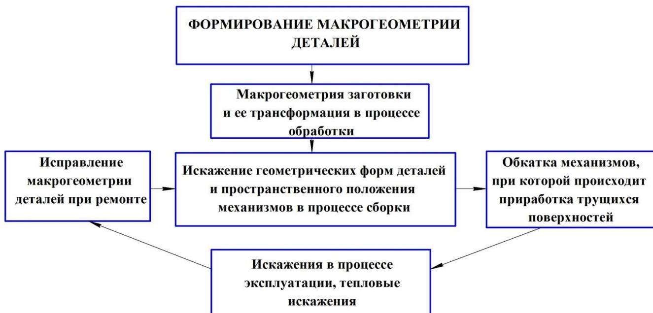
Рис.1.1 - Изменение макрогеометрии деталей в пределах жизненного цикла
