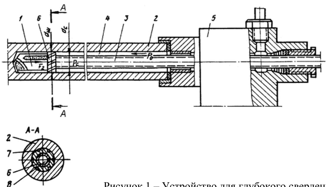
Рисунок 1 – Устройство для глубокого сверления
