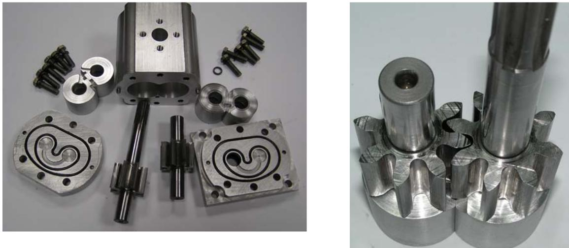
Рисунок 2 - Фотографії деталей експериментального насоса НШ-20 (32) УУРОН і елементів його качаючого вузла в зборі
