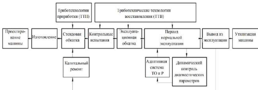
Рис. 1 - Алгоритм повышения долговечности мобильной сельскохозяйственной и автотранспортной техники
