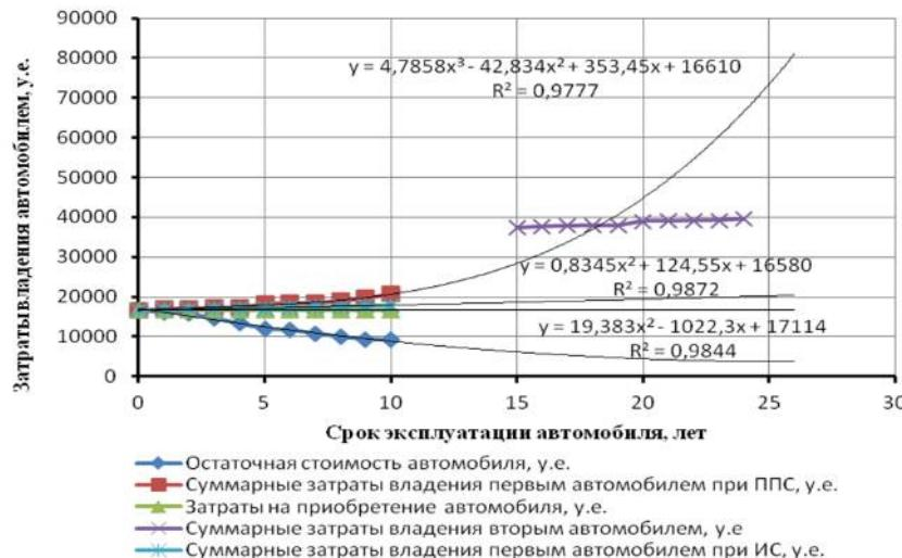
Рис. 2 - Обоснование снижения затрат владельца легкового автомобиля с использованием существующей стратегии ТО и Р
