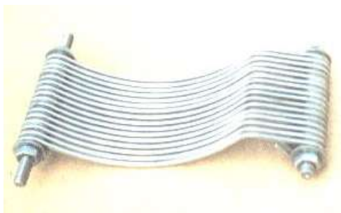
Рис. 1. Основні елементи багатофункціонального робочого органу – дуговидна решітка та лопатевий ротор.
