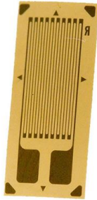
Рисунок 3.5 – Фолієвий тензоопір: 1 – стрічка; 2 – підкладка; 3 – струмовивідні кінці.
