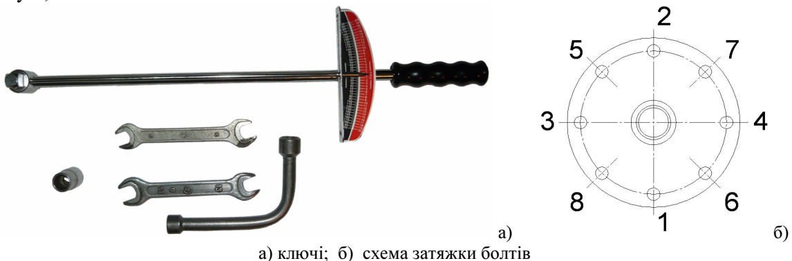
Рисунок 4 – Ключі та схема затяжки болтів елементів роторного комплекту
