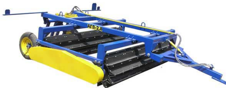
Рисунок 2 – ПРР з горизонтальною віссю обертання робочих органів з приводом вітчизняного виробництва АГП-2,8
