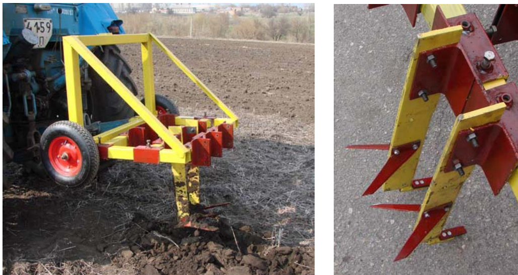
Рисунок 4 - Експериментальний адаптивний розпушувач ґрунту та його робочі органи
