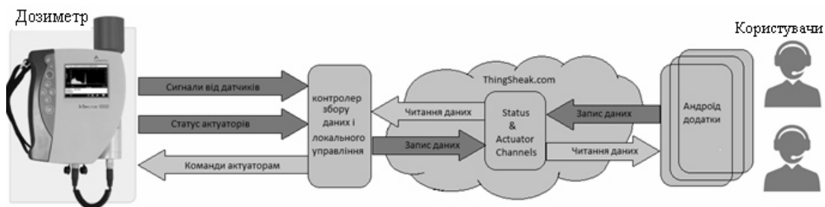
Рисунок 1 – Схема інтеграції спектродозиметрической апаратури з хмарним сервісом
