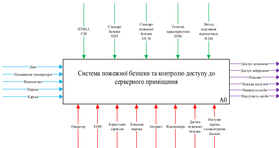
Рисунок 2 – Нульовий рівень IDEF0-діаграми комплексної системи захисту серверного приміщення
