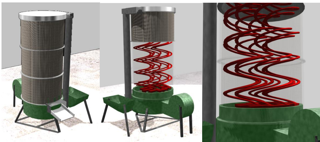
Рис. 3. Сушарка сипких матеріалів із розпушуванням шару матеріалу спіралеподібними активаторами
