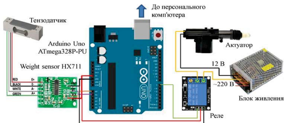
Рисунок 4 – Електрична схема керування блоку вимірювання об'ємної маси
