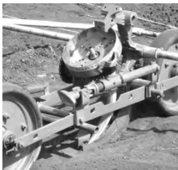
Рисунок 1.7 – Общий вид экспериментальной посевной секции с вибрационно-дисковым высевяющим аппаратом
