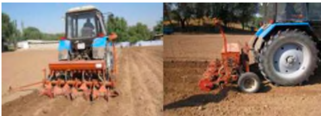
Рисунок 1.63 – Технологический процесс посева зерновых культур на гребнях сеялкой КМ-2,4 «Зироткор».
