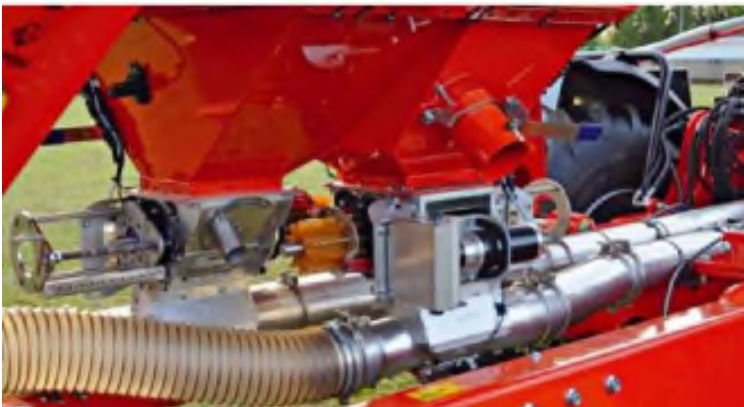
Рисунок 1.54 – Электропривод дозатора посевной машины фирмы Kuhn
