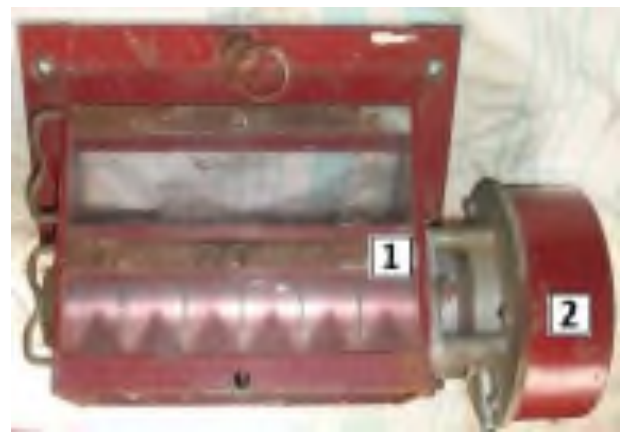
Рисунок 1.27 - Высевающий аппарат сеялки «Клен» (1) с шаговым электродвигателем (2)
