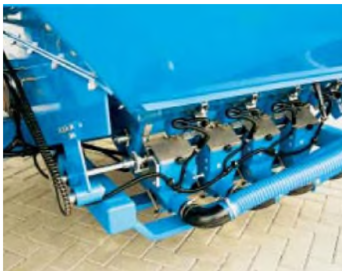
Рисунок 1.30 – Электропривод вала высевающих аппаратов сеялки Solitair 12
