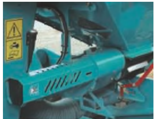
Рисунок 1.55 – Электропривод дозатора посевной машины фирмы Sulky
