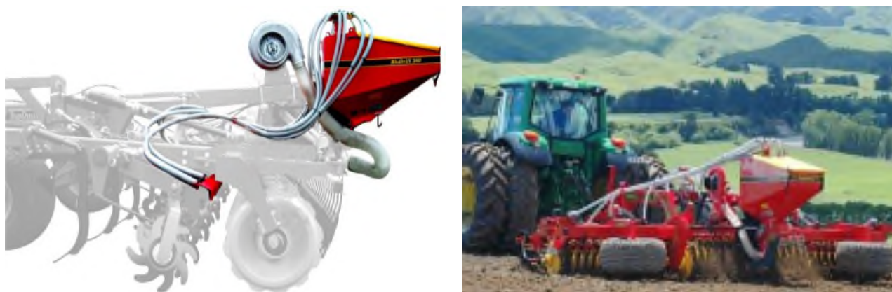
Рисунок 1.51 – Высевальное устройство BioDrill BDA 360 на культиваторах
