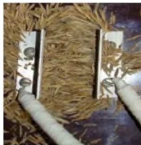
Рисунок 1.38 – Ориентация посевного материала под воздействием электрического поля
