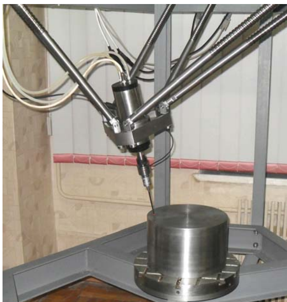
Рисунок 8 – Вимірювання оправки на верстаті
