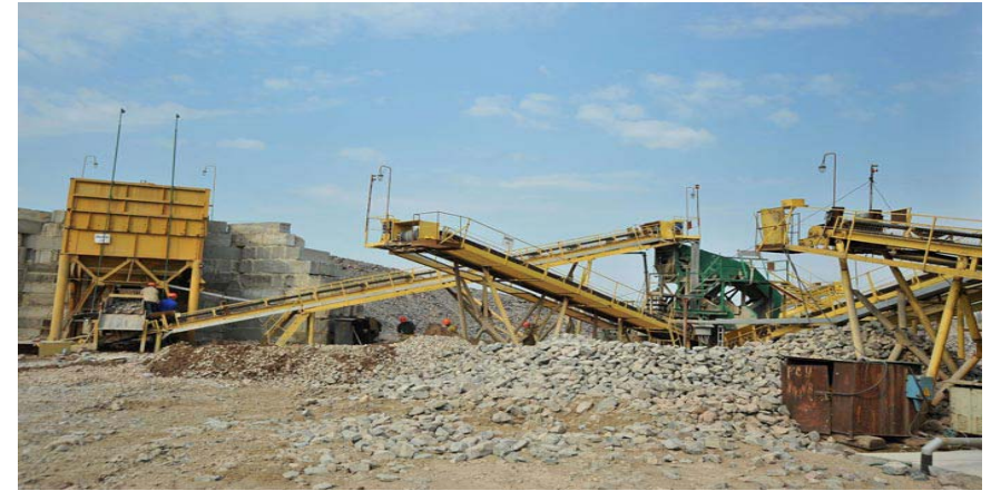
Рисунок 1 – Пересувний рудо сортувальний комплекс шахти Інгульська
