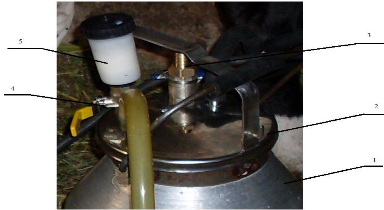
1 – доїльне відро, 2 – кришка, 3 – рідинний шаровий вентиль, 4 – повітряний шаровий вентиль, 5 – повітряний фільтр.
