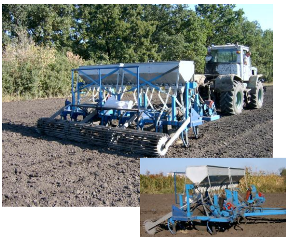
Рисунок 1 – Загальний вигляд агрегату для безполицевого обробітку ґрунту з одночасним внесенням мінеральних добрив.
