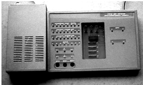
Рисунок 2 – Апаратний емулятор (стенд) мікросхеми інтервального таймера
