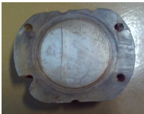
Рисунок 1. Вигляд оглядового скла після проведення експериментів з добавкою «Ramsinks-2M»
