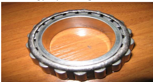
Рисунок – 3 Руйнування роликового підшипника
