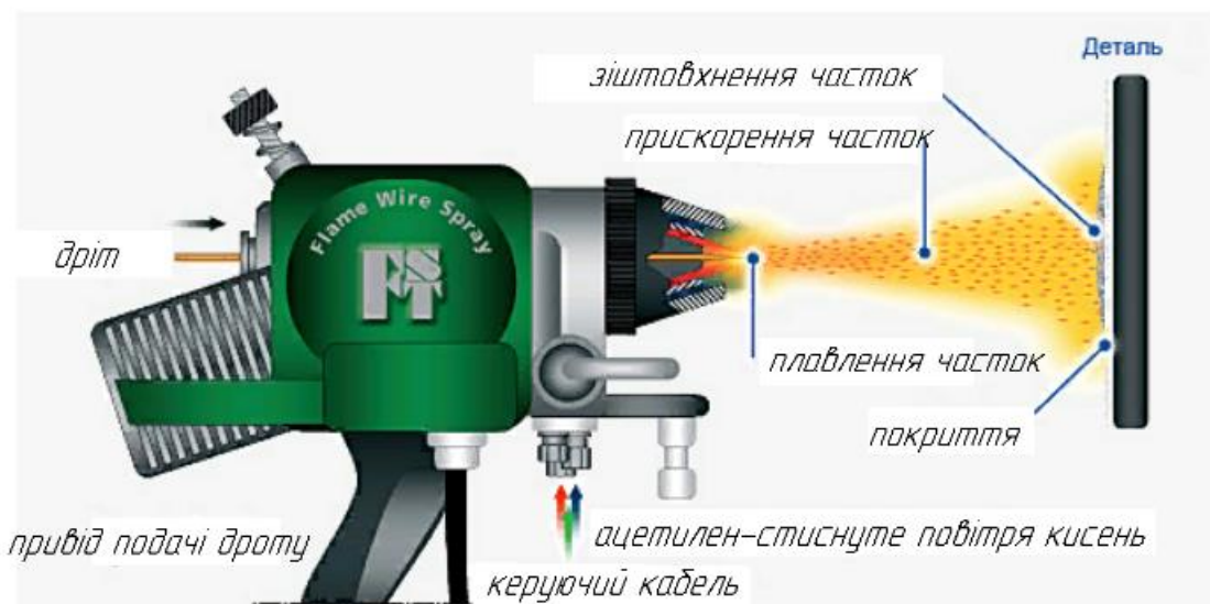
Рисунок 3.10 – Схема газополуменевого нанесення покриття
