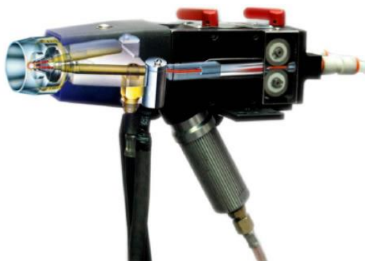
Рисунок 3.12 – Пальник для електродугової металізації
