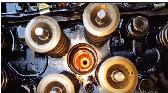
Рис. 3.49 - Нова втулка на місці
