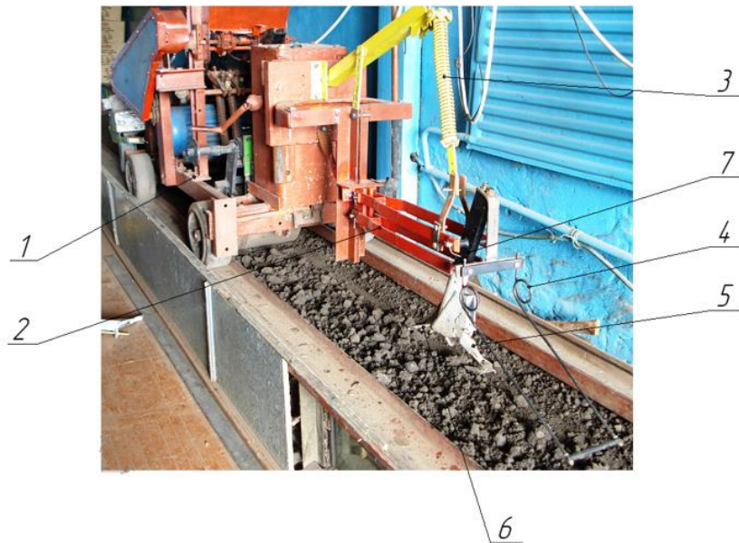
Рис. 3.4. Загальний вигляд розробленої нами установки для проведення дослідів у ґрунтовому каналі:
