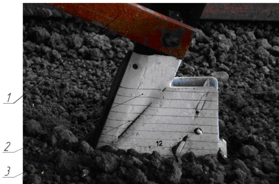
Рис. 3.9. Проведення замірів глибини при вільному заглибленні робочого елемента:
