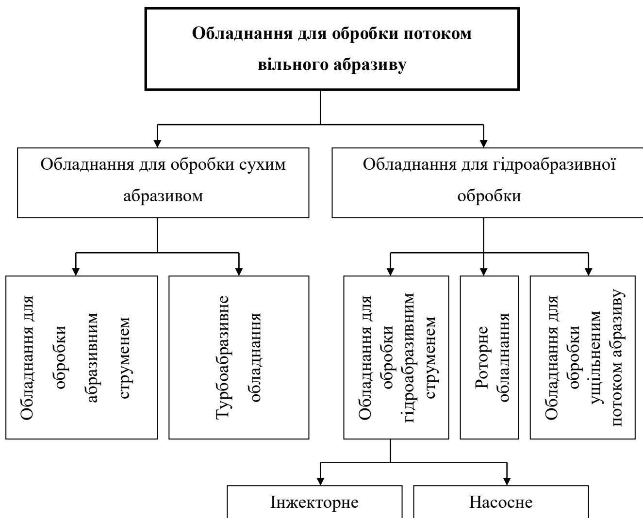
Рис. 1.2. Класифікація обладнання для обробки струменем вільного абразиву
