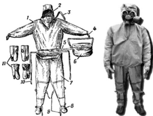
Рисунок 5.33 – Загальний вигляд легкого захисного костюма Л-1: 1 – куртка; 2 – капюшон; 3 – горловий хлястик; 4 – петля; 5 – проміжний хлястик; 6 – сумка; 7 – брюки; 8 – боти; 9 – хлястики; 10 – бретеля; 11 – рукавиця.
