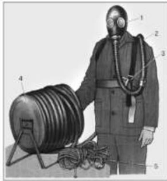
Рисунок 5.17 – Шланговий протигаз: 1 – лицева частина ШМ-62У; 2 – трубка із гофри; 3 – запобіжний пояс; 4 – барабан зі шлангом; 5 – сигнально-рятувальна мотузка.
