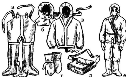
Рисунок 5.32 – Легкий захисний костюм Л-1: а – штани з панчохами; б – підшоломник; в – сорочка (куртка) з капюшоном; г – двопали рукавиці; д – сумка для зберігання костюма; е – одягнений Л-1.
