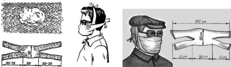
Рисунок 5.28 – Виготовлення ватно-марлевої пов'язки (розміри у см)
