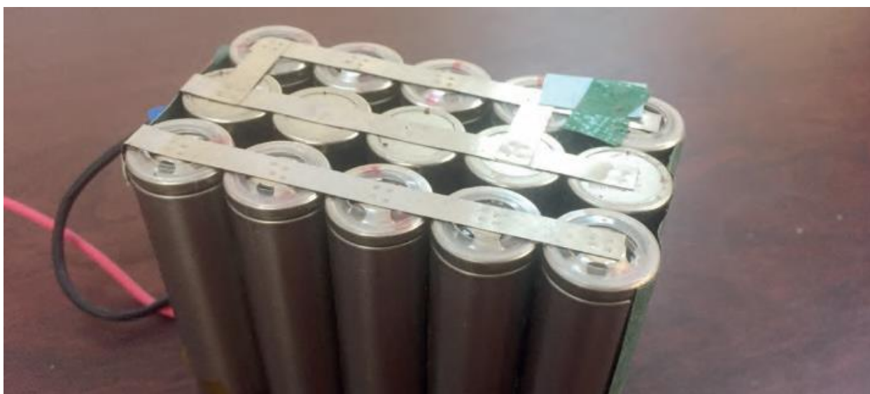
Рисунок 98 - Типове розташування літій-іонних елементів для акумуляторної батареї, що використовується на сонячних електростанціях
