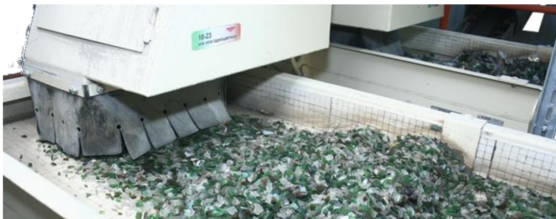
Рисунок 143 - Подрібнення скла на автоматичній лінії
