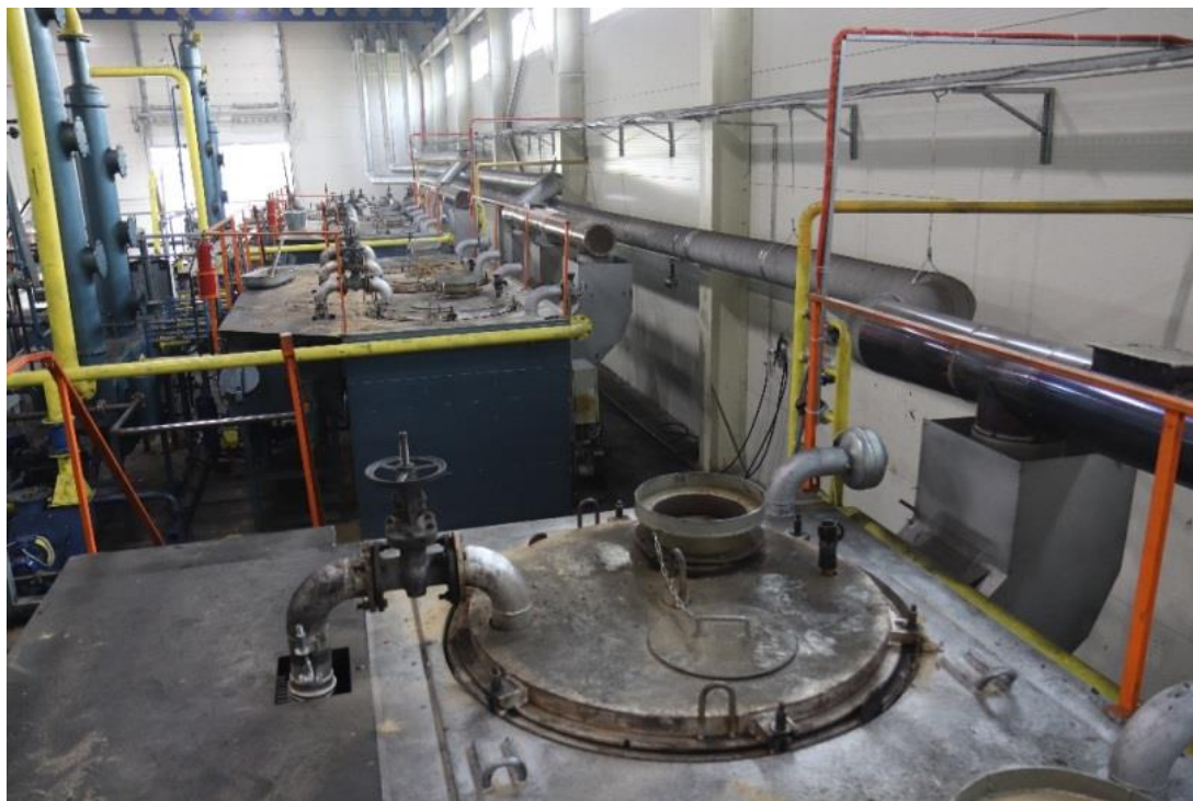
Рисунок 75 – Піролізна піч для відновлення зношених автомобільних шин методом низькотемпературного піролізу
