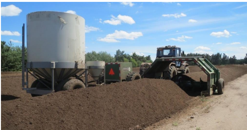
Рисунок 116 - Механізоване перетрушування та зволоження штабелів при компостуванні відходів тваринництва у польових умовах
