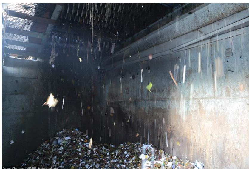
Рисунок 45 - Відсіювання дрібних органічних та біологічних відходів на вібраційному ситі
