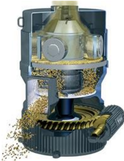
Рисунок 126 - Формування пелет в прес – грануляторі з плоскою дисковою матрицею
