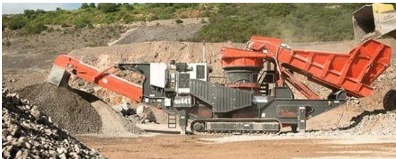
Рисунок 168 - Застосування у кар'єрі мобільної конусної дробарки на гусеничному ході
