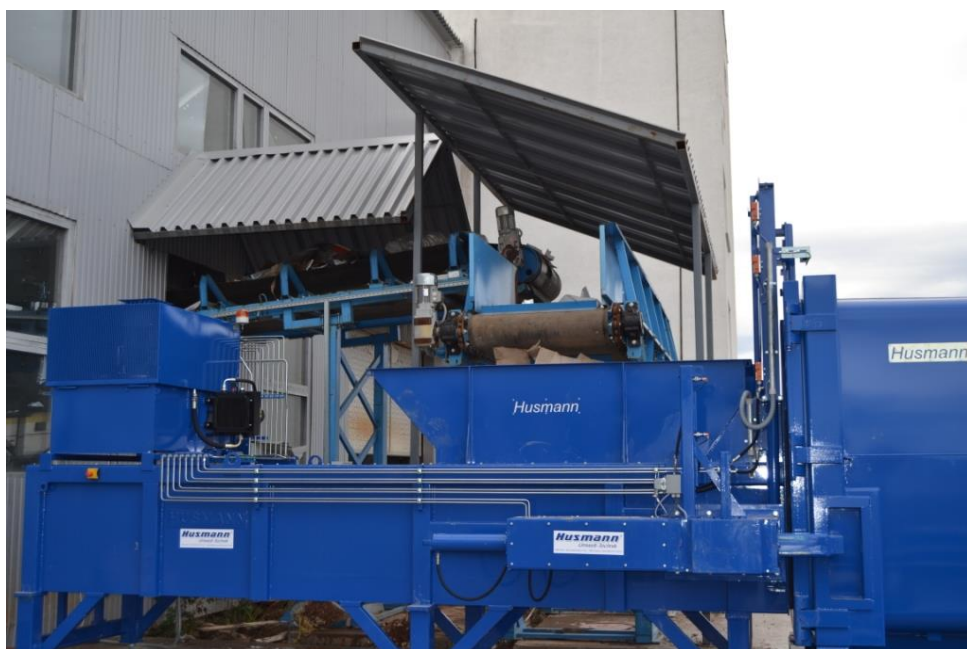
Рисунок 48 - Станція перевантаження твердих побутових відходів у прес – компактор
