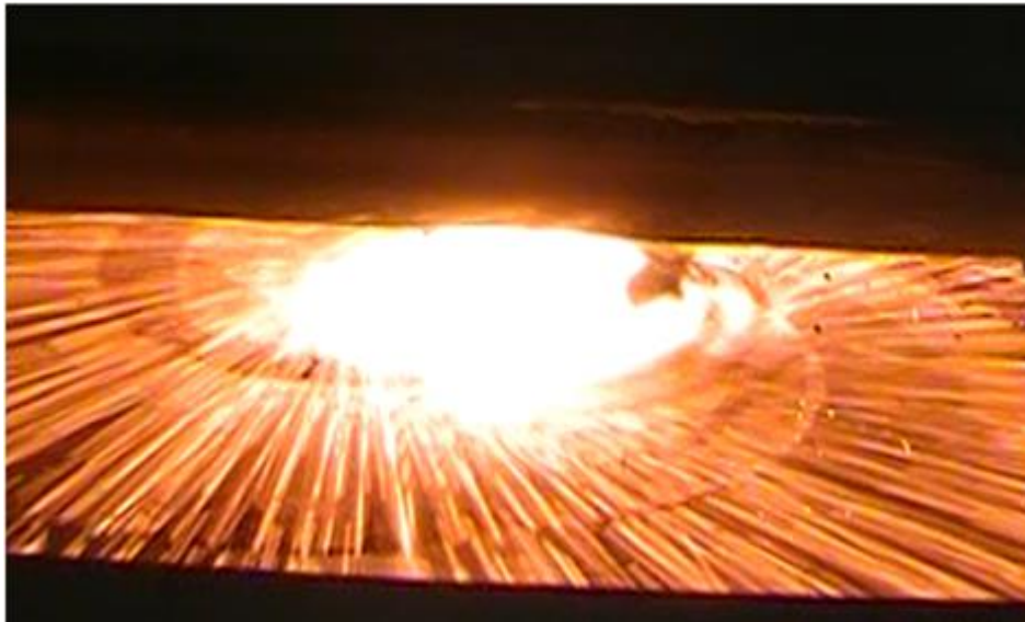
Рисунок 179 - Розпилення шлаку при сухому центробіжному способі гранулювання
