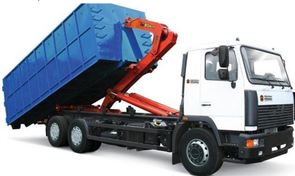
Рисунок 49 - Тягач з маніпулятором типу «multi – lift» в процесі завантаження накопичувального контейнера перед вивезенням для утилізації
