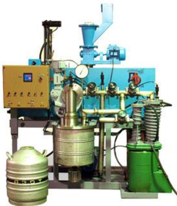
Рисунок 86 - Установка для вакуумної термічної демеркуризації люмінесцентних ламп
