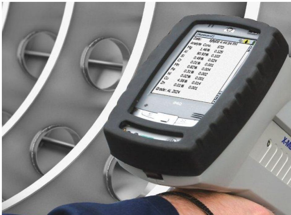
Рисунок 152 - Виведення результатів спектрального аналізу на монітор портативного рентгенфлуоресцентного аналізатора
