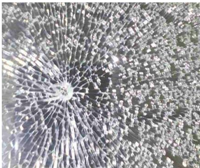
Рисунок 145 - Подрібнення триплексу при руйнуванні
