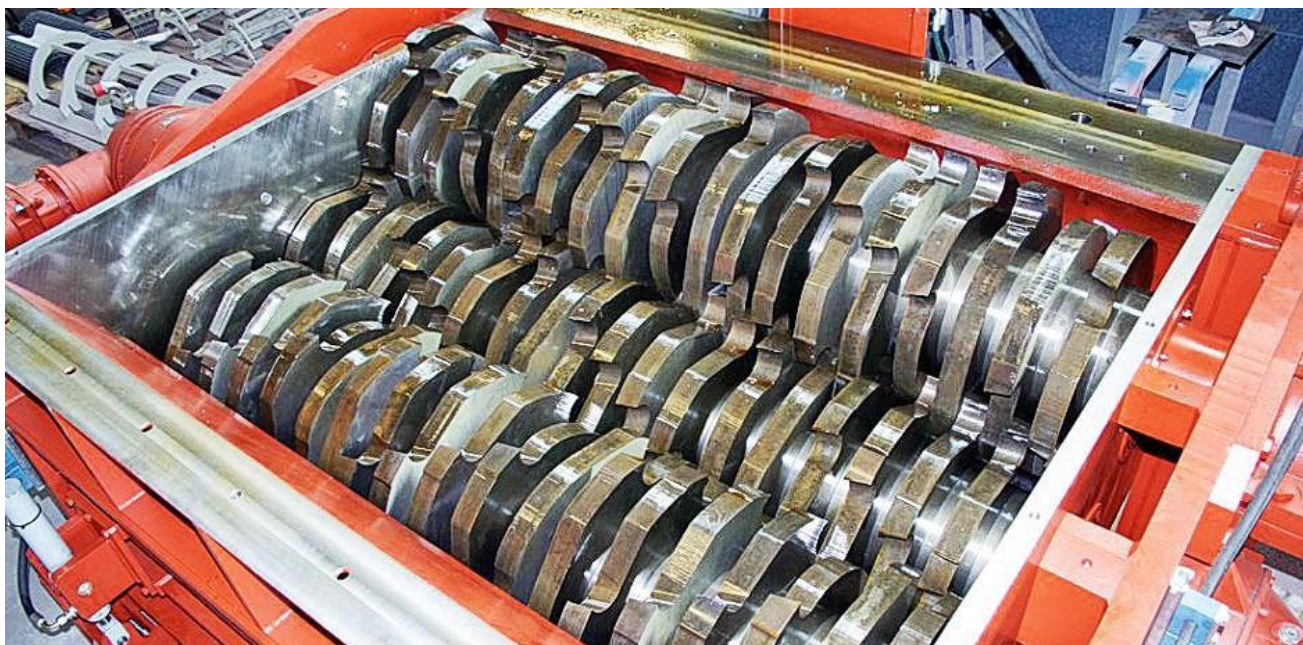
Рисунок 60 - Зовнішній вигляд ріжучої частини шредера
