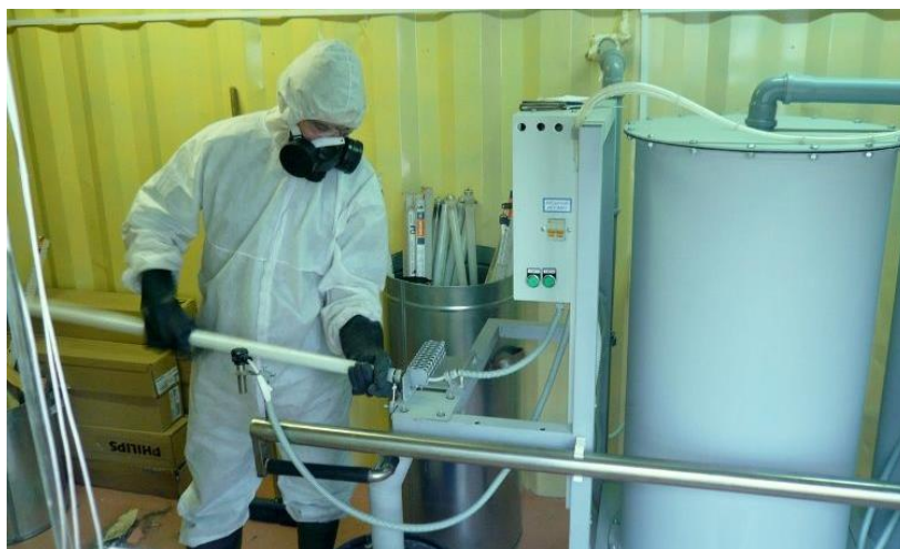
Рисунок 87 - Завантаження люмінесцентних ламп в установку вакуумної демеркуризації ртутьвмісних відходів.
