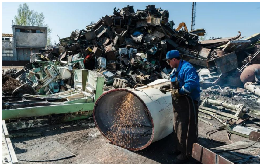
Рисунок 154 - Різання металу киснево-газовим пальником
