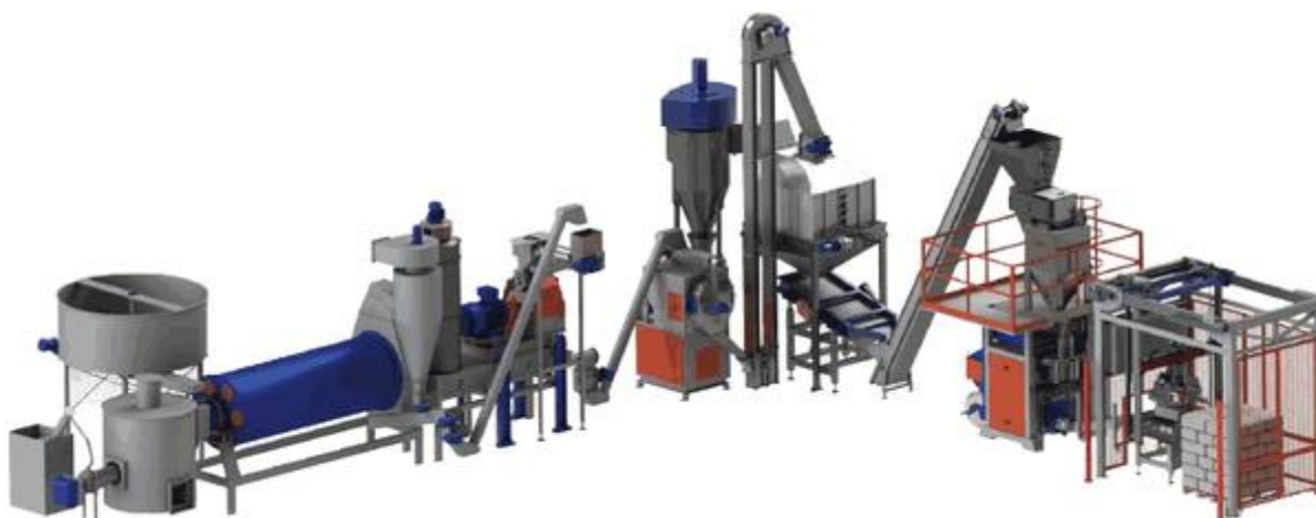
Рисунок 128 - Технологічна лінія виробництва пелет
