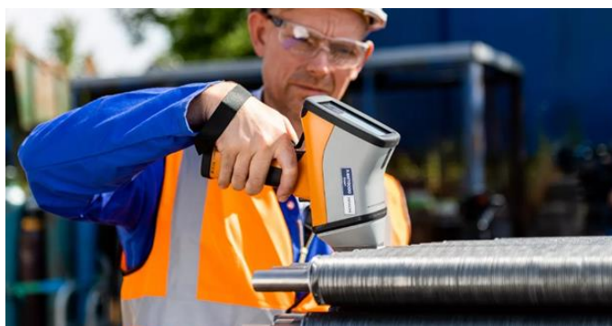
Рисунок 151 - Проведення хімічного аналізу матеріалу портативним рентгенофлуоресцентним спектрометром
