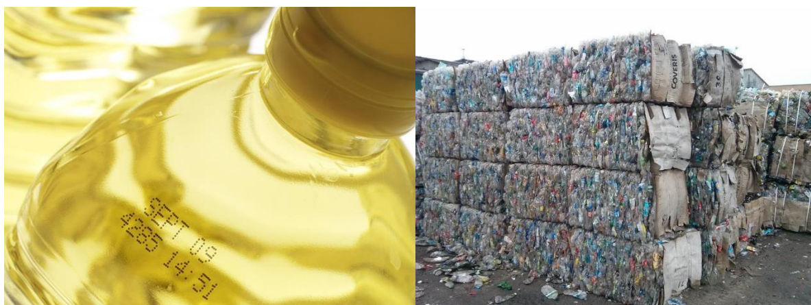
Рисунок 58 – Лазерне маркування на ПЕТ – пляшках з напоями (а); обв'язані дротом тюки з спресованих пляшок з ПЕТ перед відправкою для утилізації (б)
