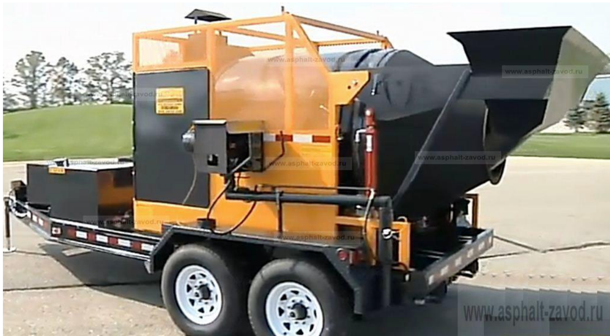
Рисунок 202 - Установка горячего рециклинга асфальтобетонных покрытий
