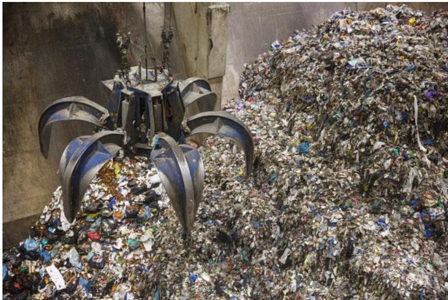
Рисунок 16 - Захват відходів грейферним краном перед завантаженням у топковий пристрій
