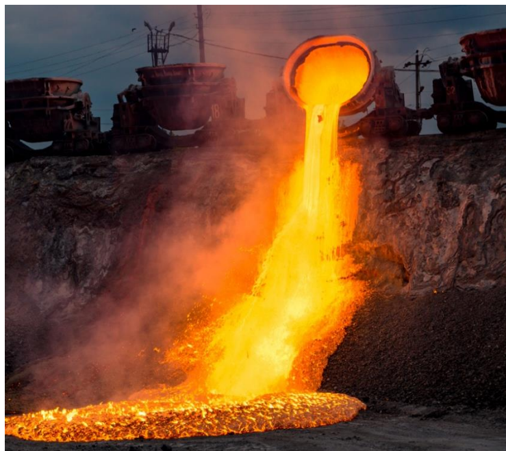
Рисунок 172 - Зливання рідкого шлаку з шлаковозів у траншею
