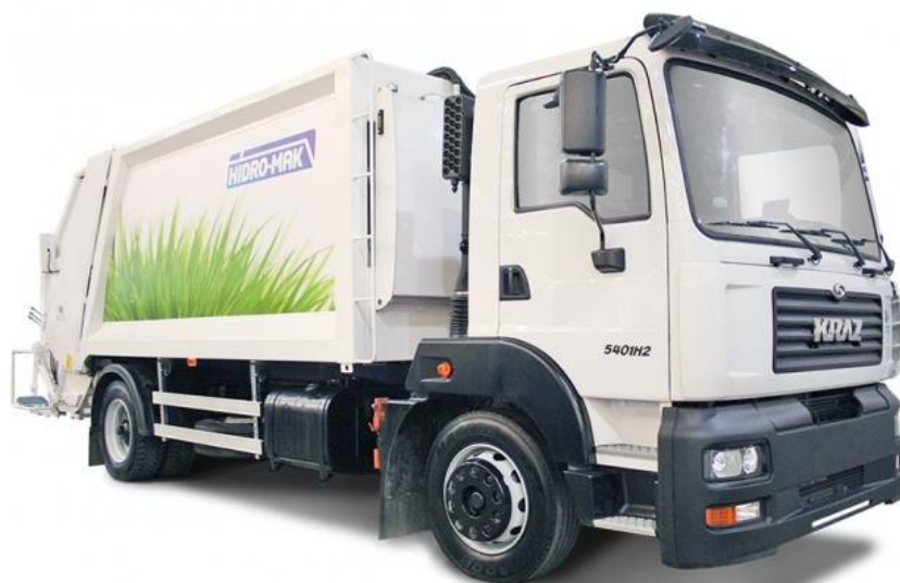
Рисунок 42 - Автомобіль-сміттевоз на базі шасі автомобіля КрАЗ-5401Н2
