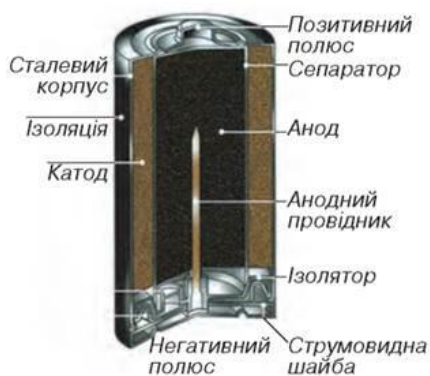
Рисунок 89 – Будова сольового (а) та лужного (б) гальванічних елементів
