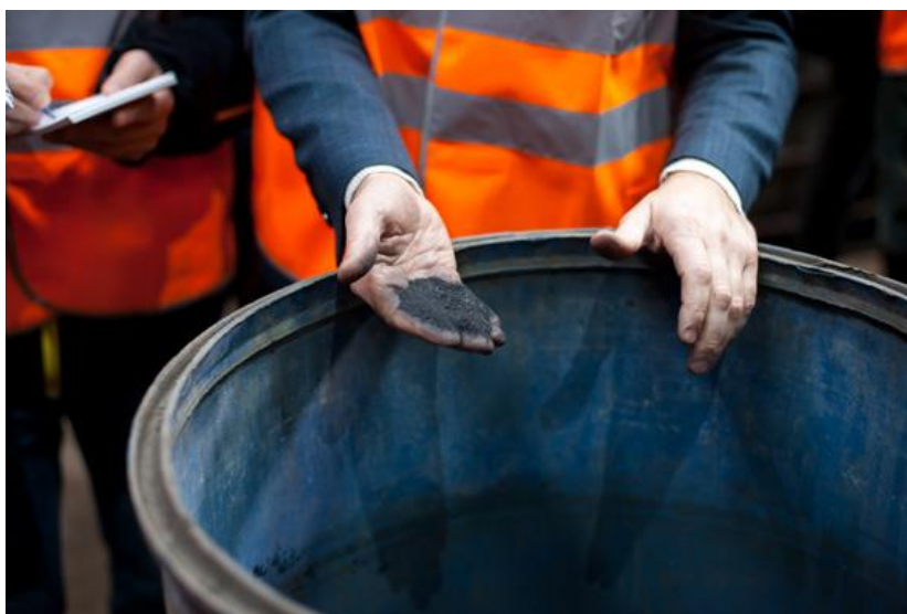
Рисунок 94 - Подрібнена шихта «чорна маса», яка отримана з подрібнених гальванічних елементів
