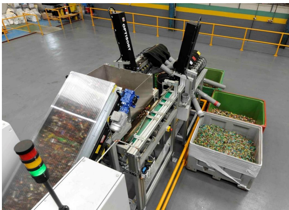
Рисунок 93 - Автоматизоване сортування автономних джерел струму
