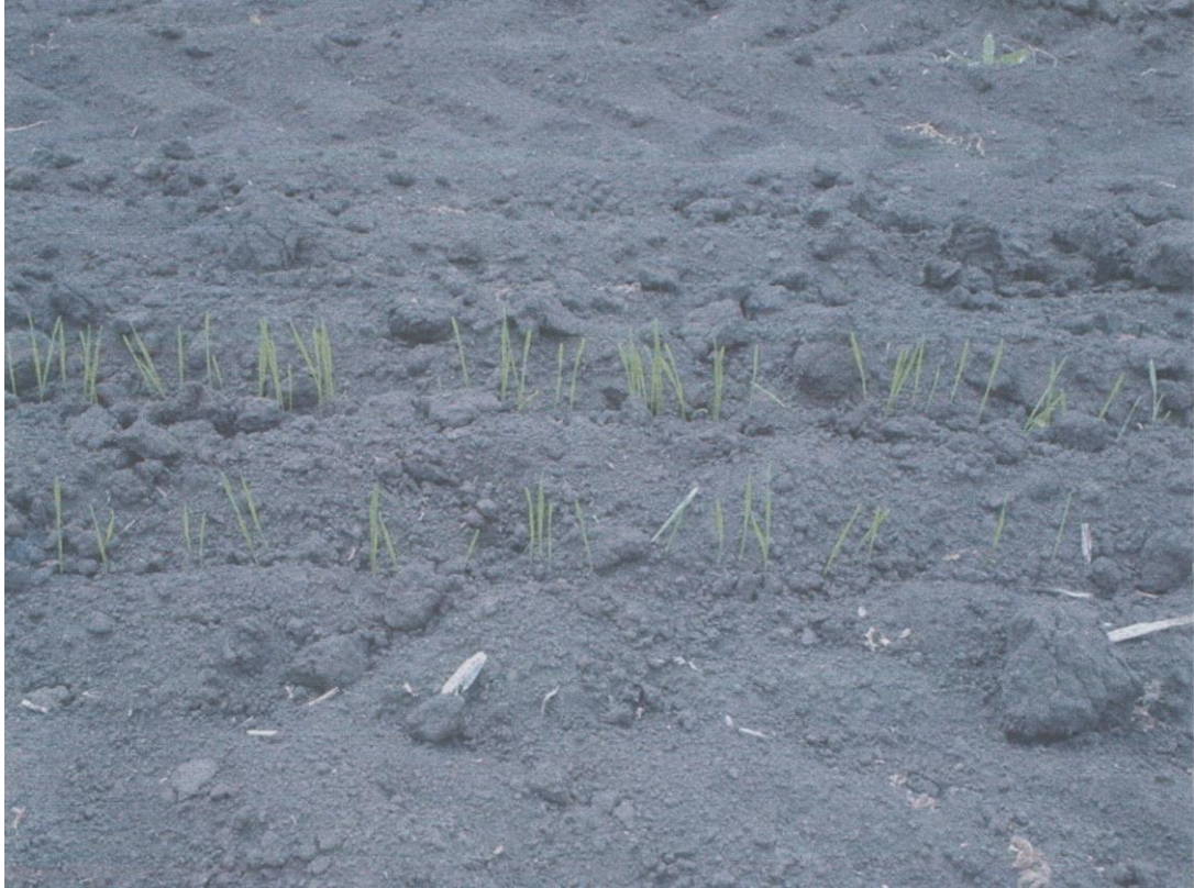
Рис. 3.6. Результати сівби озимої пшениці на дослідній ділянці: нижній рядок - серійним сошником; верхній рядок – експериментальним.
