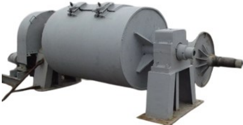
Рисунок 3.3 - Галтувальний барабан періодичної дії 41114
