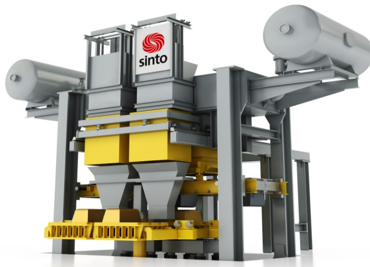
Рисунок 3.2 - Автоматизована формувальна лінія SINTO ZFA-S
