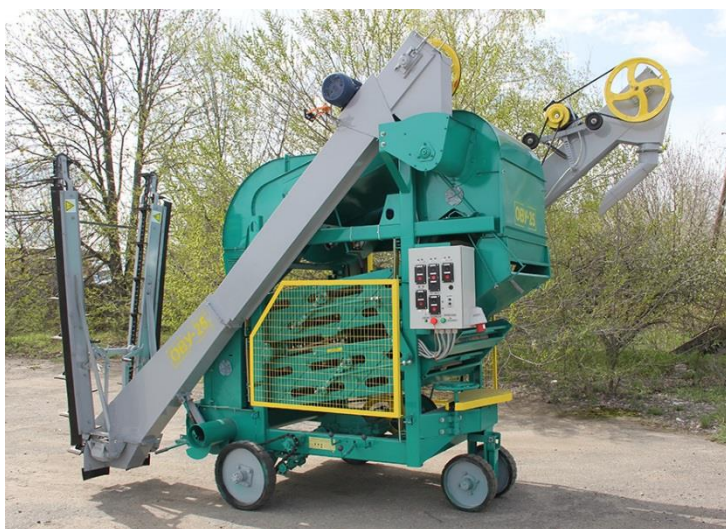
Рис. 3.9. Загальний вигляд ворохоочисника ОВС-25
