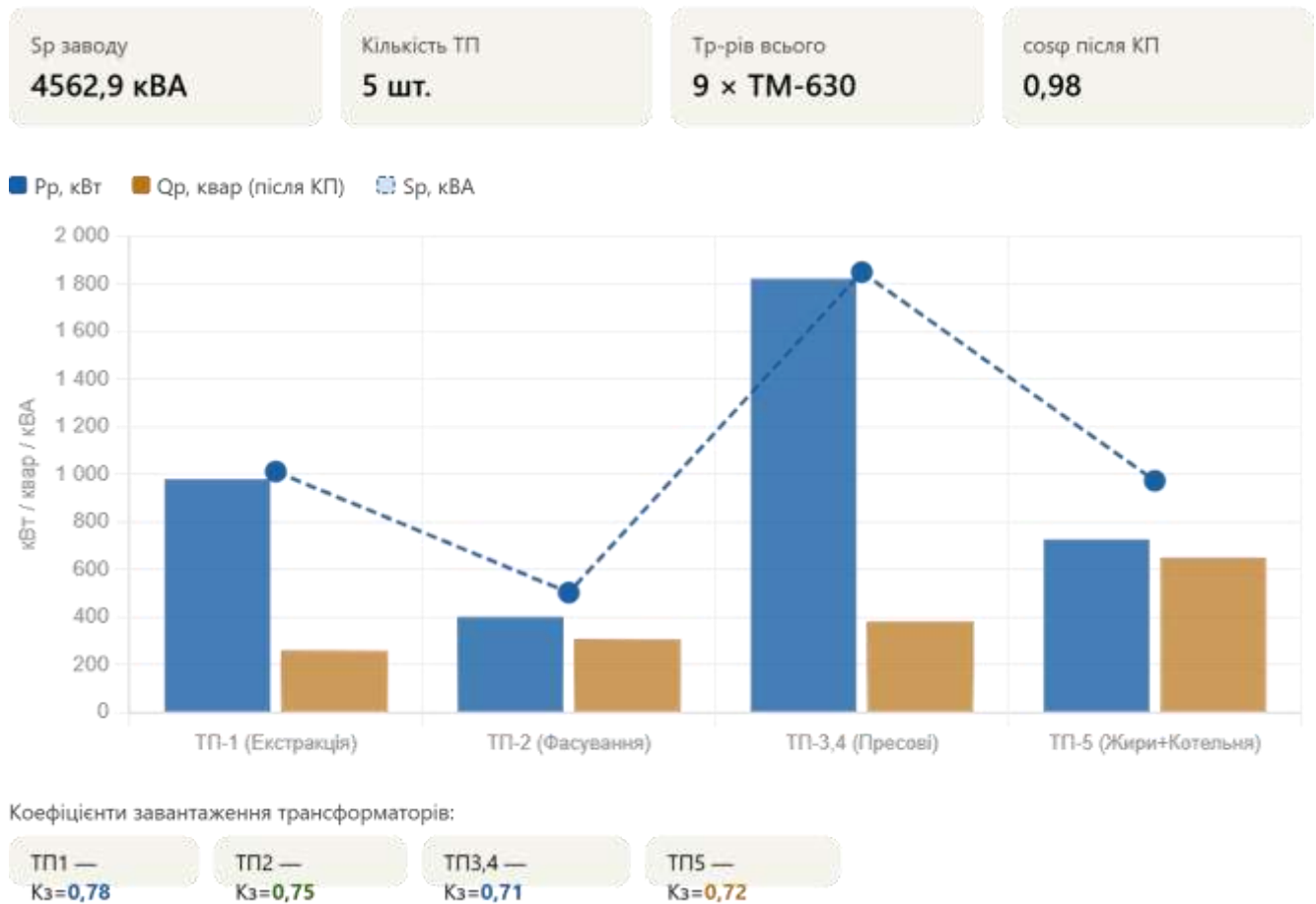
Рисунок 7.8.2- Розподіл електричного навантаження між підстанціями заводу
