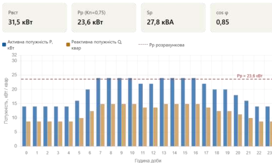
Рисунок 7.7.1 - Добовий графік електричного навантаження котельні ОЕЗ
