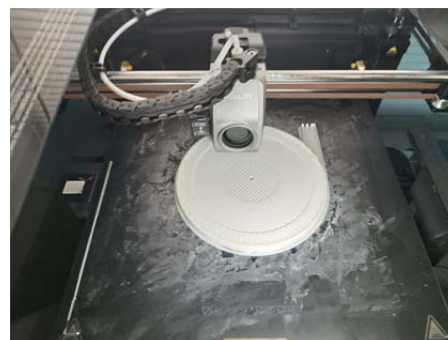
Рисунок 3 – Фрагмент інтерфейсу програми Creality Print і процес 3D друку чаші проєктного віброживильника принтером Creality K1 Max філаментом ABS+
