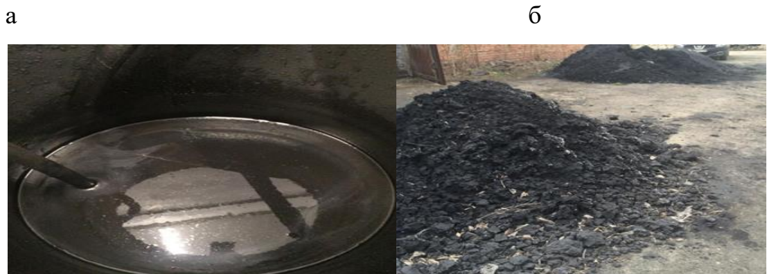
Рис. 4.8 – Загальний вид вугільного шламу, промпродукту (б) та ВВС з них (а).
