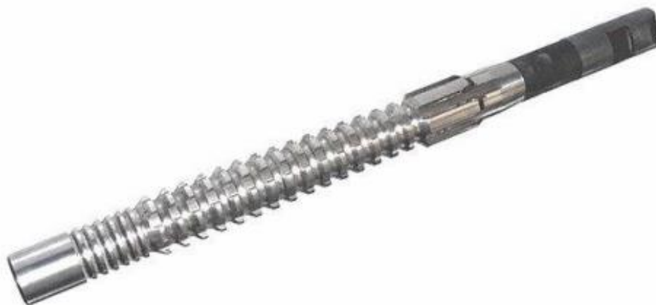
Рисунок 1.7 – Приклад конструкції внутрішньої шліцьової протяжки
