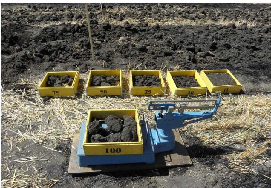
Рис. 3.10. Визначення фракційного складу ґрунту за допомогою решітного класифікатора
