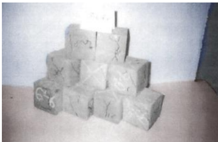
Рисунок 2.2 - Характер руйнування дослідних зразків при дослідженні міцності на стиск
