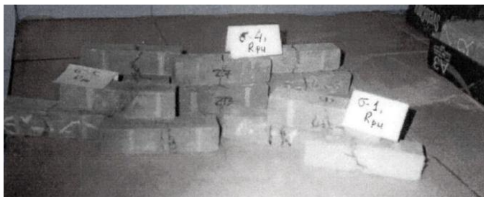
Рисунок 2.4 - Характер руйнування дослідних зразків при дослідженні на розтяг при згині
