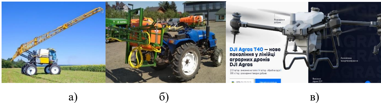
Рис. 2.8 – Знаряддя для обробітку полів хімзасобами: а – самохідний IBIS 3000-24 ви-ва Богуслав; б – навісний ОГН-200; в – агродрон
