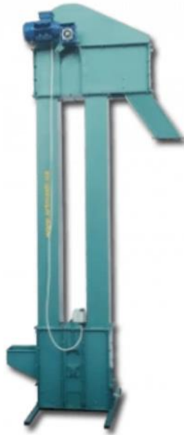
Рис 3.2. Загальний вигляд норії зернової НК-7,1+ТОВ «АРТМАШ» (Вінницька обл. м. Жмеринка).
