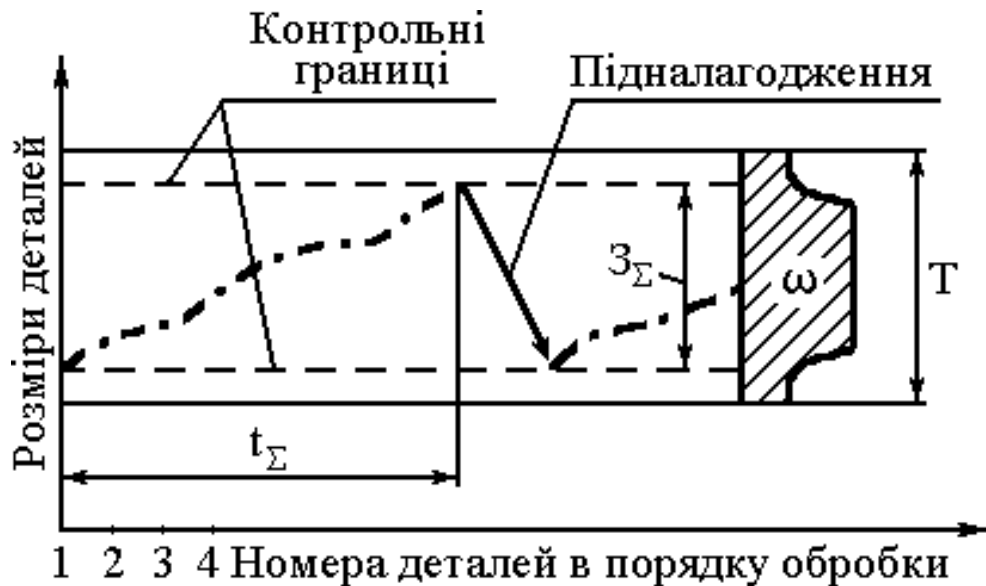
Рисунок 8.2 – Графік зміни розмірів оброблюваних деталей внаслідок зносу інструмента
