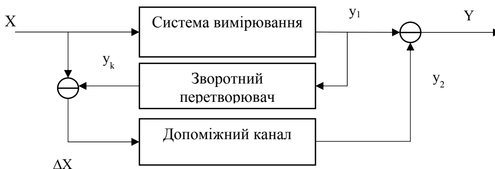
Рисунок 1 – Структурна схема засобу вимірювання з адитивною корекцією похибки Джерело: розроблено автором на основі джерела [2]
