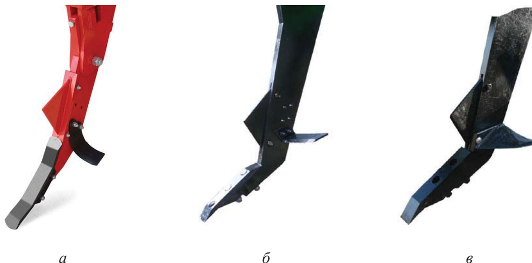
а – крила на чизельних лапах фірми Gaspardo; б – плоскі крила; в – крила з криволінійною робочою поверхнею
