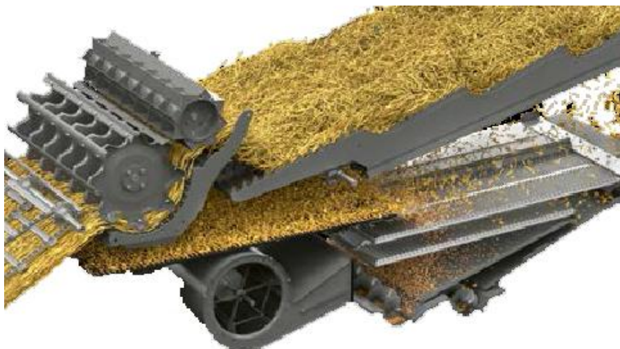
Рис. 3.1. Системи обмолоту, сепарації та очищення комбайна CLAAS EVION
