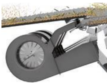
Рис. 3.2. Аспірація системи очищення комбайнів CLAAS LEXION 650–670
