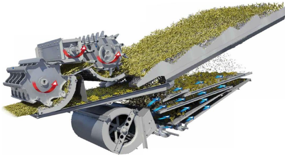
Рис. 3.14. Системи обмолоту, сепарації та очищення комбайнів NEW HOLLAND серії TC
