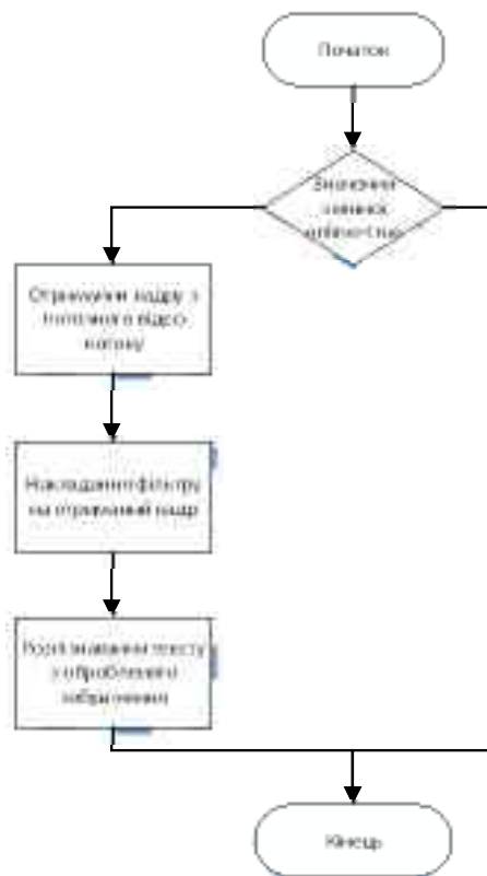
Рисунок 4.17 – Блок схема роботи блоку програмного коду розпізнавання номеру вагону.
