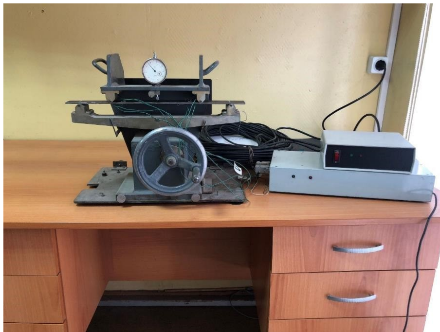
Рисунок 31 – Тарувальний пристрій з підключеним ММТС-64.01
