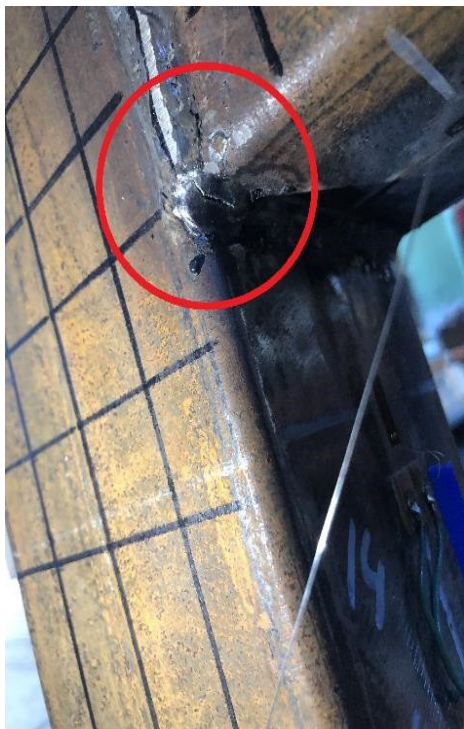
Рисунок 36 – Характер руйнування зразка О1: а) фізичні випробування; б) еквівалентні напруги по МКЕ
