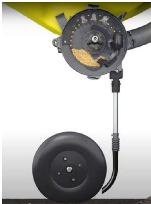
Рис. 3.9. Схема висіву насіння висівним апаратом сівалки Tempo V
