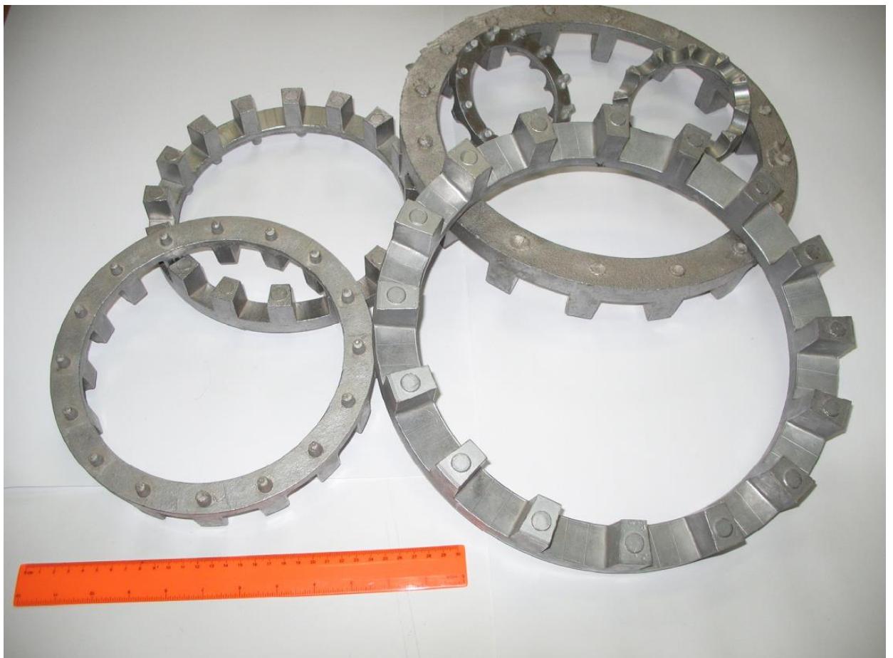
Рис. 2.3. Виливок, одержаний з застосуванням нетверднучої розосередженої ливниково-живильної системи під низьким електромагнітним тиском
