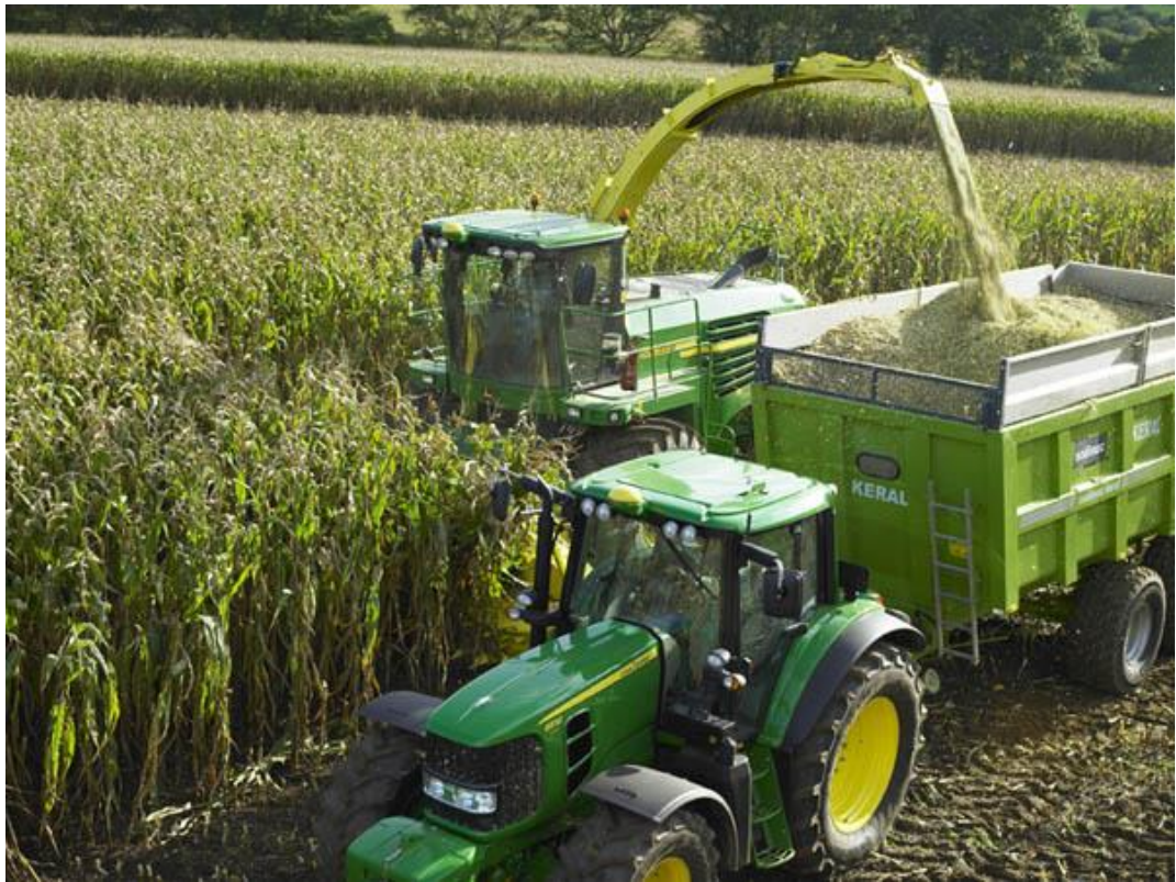
Рис. 3.3. Операція збирання силосної кукурудзи самохідним комбайном марки John Deere 7350
