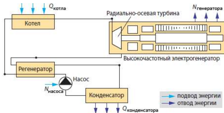
Рисунок 3.6 - Схема утилізації низькопотенційного тепла заснована на використанні циклу Ренкіна
