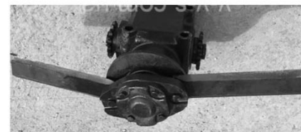
Дискові різальні апарати: а) підрізного різання: 1– ніж, 2– диск, 3– стебло, 4– вісь, 5– протиріз
