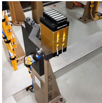
Рис.2.4. Магнітний захватний пристрій
