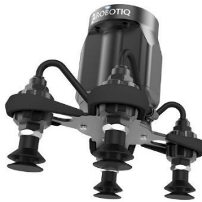
Рис.2.3. Вакуумний захватний пристрій
