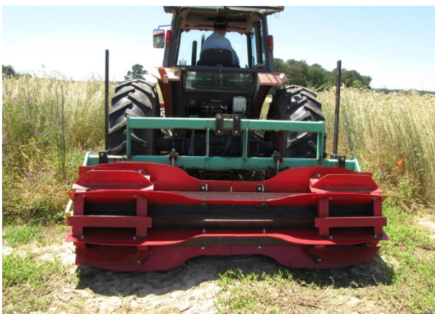
Рисунок 3 – Коток-подрібнювач з випуклими ножами конструкції Landy R. Rapier (Агроінженерний коледж університету штату Алабама, США) [2]
