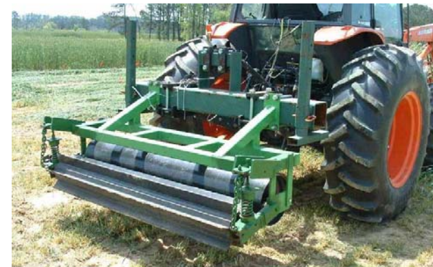
Рисунок 1 – Коток-подрібнювач з прямим розташуванням ножів-лез конструкції Ted S. Kornecki (Агроінженерний коледж університету штату Алабама, США) [2]
