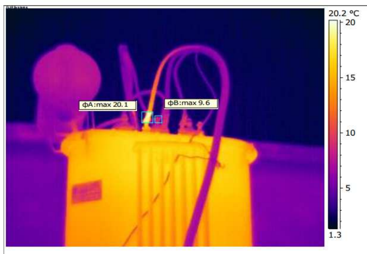
Рис. 4.6. Термограма дефектного з'єднання трансформатора власних потреб
