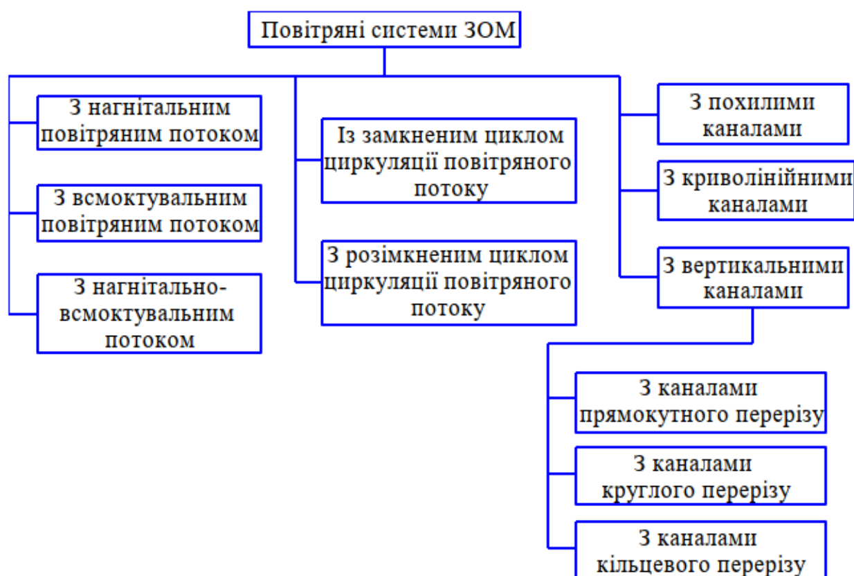
Рис. 7. Класифікація існуючих повітряних систем зерноочисних машини загального призначення
